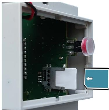
Pour installer la carte nano SIM, déclipsez la face avant du produit à l'aide d'un tournevis plat, le connecteur destiné à la carte nano SIM se situe perpendiculairement à la face avant.
