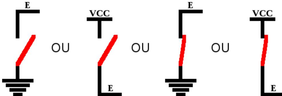
Afin d'illustrer le principe de détection nous utiliserons, dans l'exemple suivant, un état repos avec un contact ouvert au repos coupant et amenant la tension  $V_{CC}$  (12V) en cas d'alarme, soit le cas n°2
