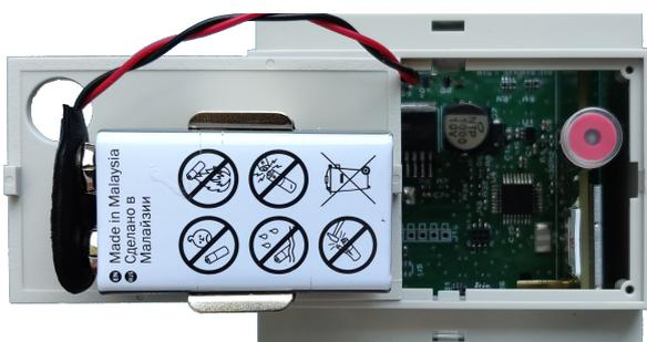
Le rôle de cette pile est de vous envoyer un SMS d'alarme en cas de coupure d'alimentation électrique. Sa durée de vie est fonction du nombre de coupures d'alimentation électriques, elle peut être supérieure à 5 ans.
