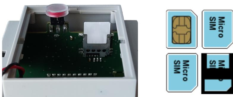
**⚠ Lors de l'insertion de la carte micro SIM le produit doit être hors tension.**
