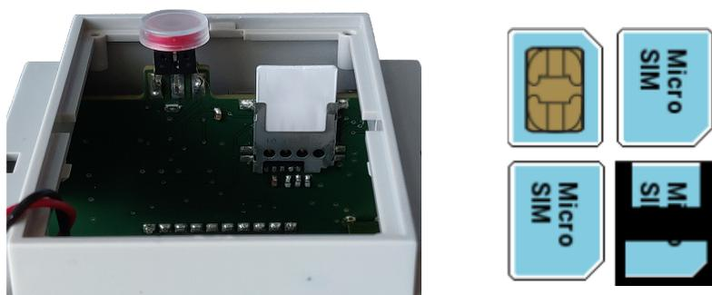
**⚠ Lors de l'insertion de la carte micro SIM le produit doit être hors tension.**
