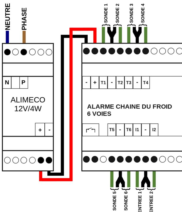
Les deux entrées d'alarmes (**I1** et **I2**) peuvent servir par exemple pour la détection d'une ouverture de porte de l'un de vos équipements, une intrusion dans les locaux, etc
